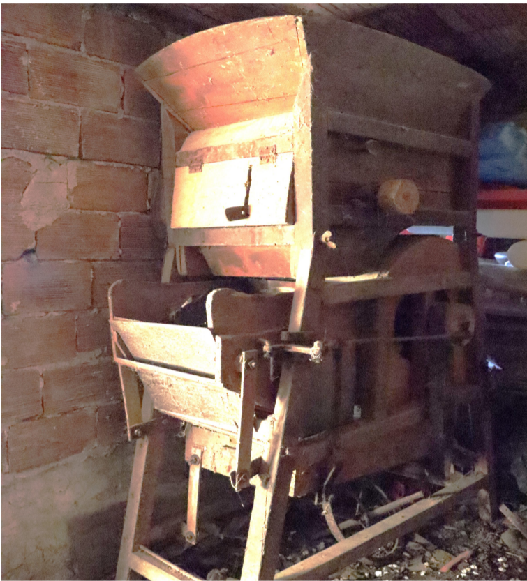
Ormai rarissima la macchina per la sbucciatura delle castagne essiccate (proprietà dell'Autore)
